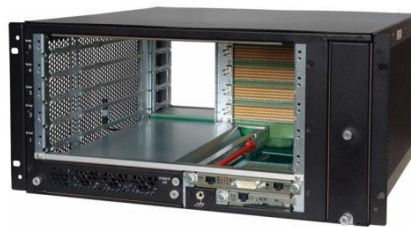
非冗余 5槽 ATCA 系统 - 1 PSU 电源 - 1 风扇盘 - 1 机箱管理板
