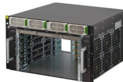
冗余 6槽 ATCA 系统 - 4 PSU 电源 (N+N) - 2 风扇盘 (Push-Pull) - 2 机箱管理板
